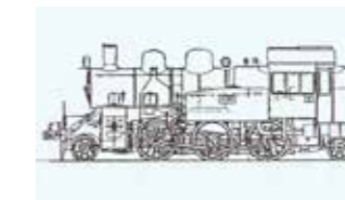
④C12形 昭和8年に5両配置された。簡易線用に製造されたタンク機関車で、動輪が小さく、除煙板がついていない。
