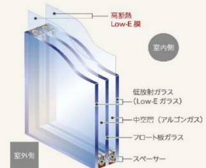
Low-E 三層複層ガラス (Low-E 2枚) アルゴンガス封入
